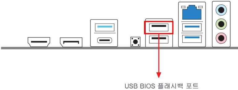
ASRock BIOS 플래시백 기능을 사용하면 시스템 전원을 켜지 않고, 심지어 CPU 없이도 BIOS를 업데이트할 수 있습니다.
